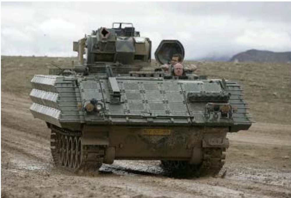
Afb.9 Testrit in Uruzgan met een YPR waarop ERA pantsering is aangebracht. (Defensie Materieelorganisatie)
