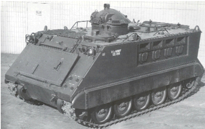
Afb. 3 Mechanized Infantry Combat Vehicle . M113 met schietpoorten en toren voor 20 mm kanon. (Hunnicut, Bradley)
