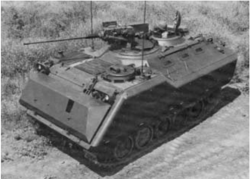
Afb. 4 De XM 765 (X staat voor experimenteel), de voorloper van de YPR. Hij heeft al veel kenmerken van de YPR, maar de koepel is hier bijvoorbeeld nog in het midden geplaatst. (Legerkoerier oktober 1977)
